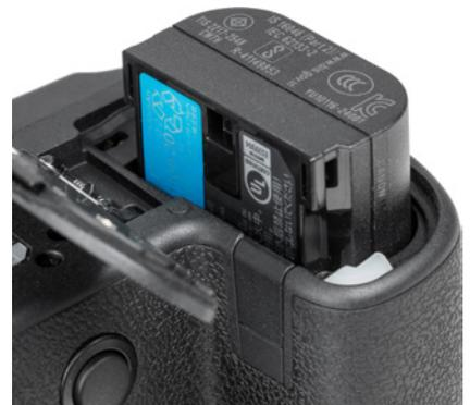
▲ Einlegen des Akkus nach Beiseiteschieben der weißen Akkuverriegelung.
