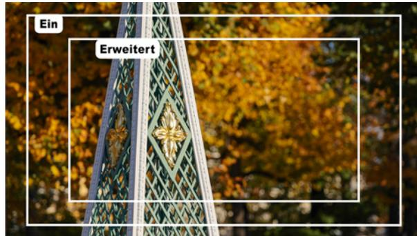
▲ Die eingezeichneten Rahmen verdeutlichen den Beschnitt des Bildes durch den Digital-IS im Modus Ein und Erweitert.
