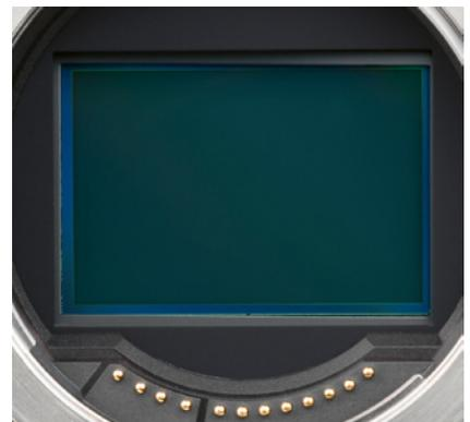
▲ Blick auf den stacked CMOS-BSI-Sensor bei eingeschalteter Kamera. Das RF-Bajonett hat unten zwölf Kontakte für die Kommunikation zwischen Objektiv und Gehäuse.
