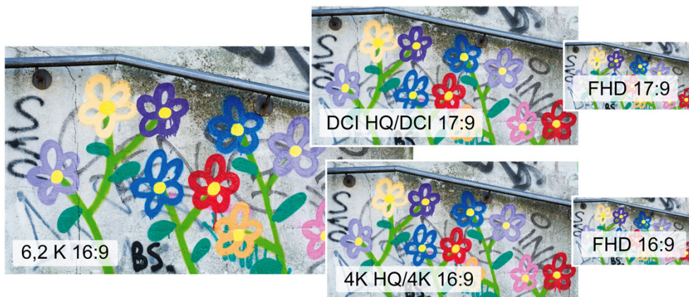
▲ Videobildgrößen der X-T50: 6,2K (6.240 × 3.510/16:9), DCI HQ und DCI (4.096 × 2.160/17:9), 4K HQ und 4K (3.840 × 2.160/16:9), FHD 17:9 (2.048 × 1.080) und FHD 16:9 (1.920 × 1.080).
