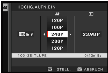
▲ Die Zeitlupenstärke hängt von der Kombination der Bildraten für die Aufnahme und die Wiedergabe ab.
