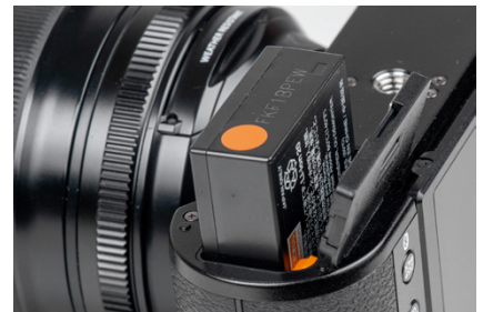
▲ Einlegen des Akkus vom Typ NP-W126S (7,2 V, 1200 mAh, 8,7 Wh).
