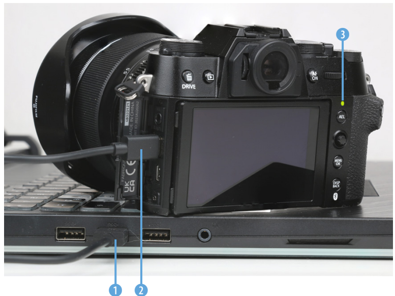
▲ Akku der X-T50 über das mitgelieferte USB-Kabel am Laptop aufladen.
