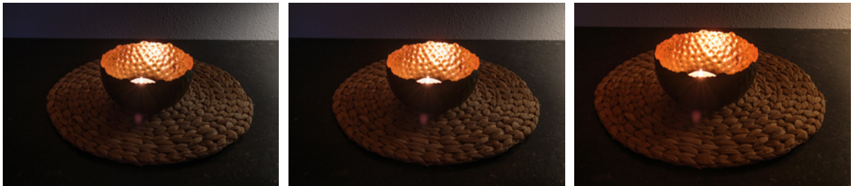
▲ Die drei Weißabgleichautomatikeinstellungen im Vergleich. Links: WB-W, Mitte: WB-AUTO und rechts: WB-A.
