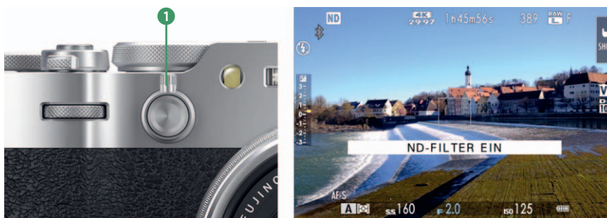
Abbildung 2.28 Halten Sie den kleinen Hebel 1 der Sucherauswahltaaste so lange nach rechts gezogen (von hinten betrachtet), bis der Text ND-Filter ein erscheint; der ND-Filter reduziert das einfallende Licht jetzt um 4 Blendenstufen. Links oben finden Sie das ND-Symbol, das anzeigt, dass der ND-Filter aktiviert wurde.
