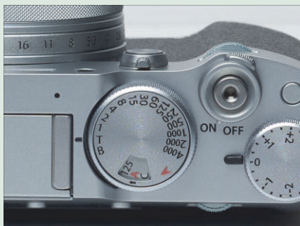
Abbildung 2.12 Stellen Sie das Einstellrad auf T , können Sie alle Belichtungszeiten inklusive der Drittelseiten über das hintere Einstellrad wählen.
