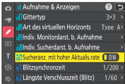
Abbildung 7.4 *Die Bildfrequenz des Suchers können Sie von 60 auf 120 Bilder pro Sekunde erhöhen.*
