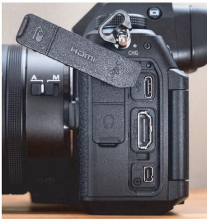
**Abbildung 1.6** Über den USB-C-Anschluss können Sie die Kamera mit Strom versorgen und den Akku laden. Etwas darüber sehen Sie die mit **CHG** markierte LED.
