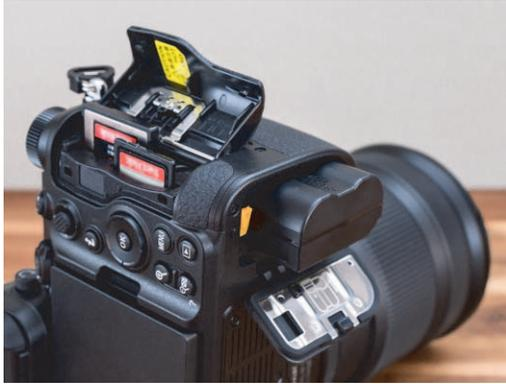
**Abbildung 1.5** Das Speicherkartenfach wird seitlich geöffnet, den Akku setzen Sie von unten ein. Achten Sie darauf, dass die orangefarbene Akkusicherung einrastet.
