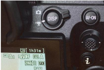
Abbildung 6.2 Für die Videoaufnahme stellen Sie den Wahlschalter auf das Filmkameranymbol.
