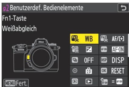
Abbildung 6.9 Die Tastenfunktionen für den Videomodus stellen Sie in der Individualfunktion g2 ein.
