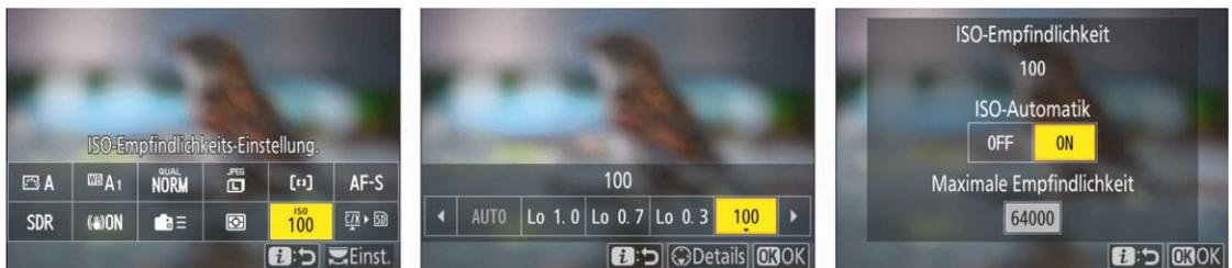
Abbildung 3.11 Einstellung der ISO-Empfindlichkeit und der ISO-Automatik im i-Menü mit dem Multifunktionswähler
