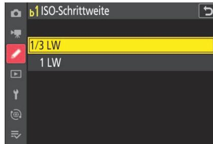
Abbildung 3.8 Die ISO-Schrittweite können Sie von 1/3 LW auf ganze Lichtwertstufen umstellen.
